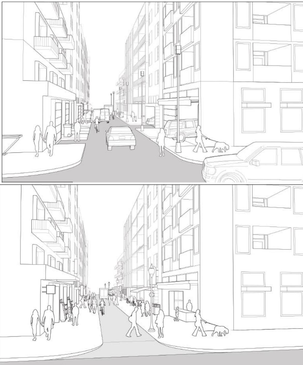
Figura 86: Exemplo de expansão de calçadas – Antes x Depois. Fonte: Global Street Design Guide.
